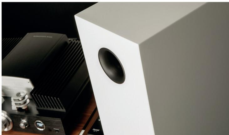
Über die Bassreflex-Öffnungen wird die Box tonal abgestimmt. Einer der beiden Flansche am oberen Ende des Gehäuses. Die Ports sind nahtlos, also aus einem Stück gefertigt, das minimiert zusammen mit der gerundeten Öffnung die Strömungsgeräusche der hier durchfließenden Luft.
