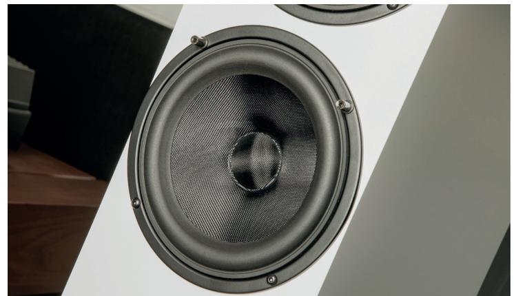
*Der Tieftöner besitzt wie der Mitteltieftöner eine Membran aus Glasfasergewebe. Von den Befestigungsschrauben des Speakers sind – wie auch beim Konus-Kollegen – zwei Stück als herausragende Stifte ausgelegt. Sie dienen der Fixierung der aufsetzbaren Frontblende. Durch diese Integration bleibt die Stirnseite frei von optisch störenden Elementen.*
