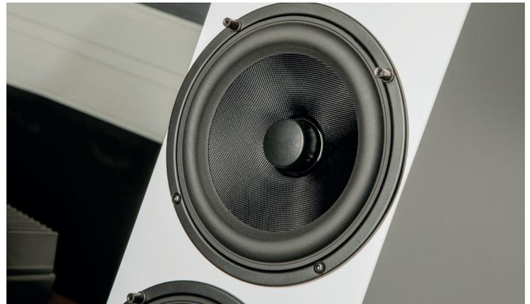
*Der Mitteltieftöner muss am meisten Arbeiten, darum hat er zur Wärmeableitung einen Phase Plug. Für den sicheren Sitz des Speakers und zur Vibrationsvermeidung werden die Befestigungsschrauben im Gehäuse von Neopren-Dübeln aufgenommen.*
