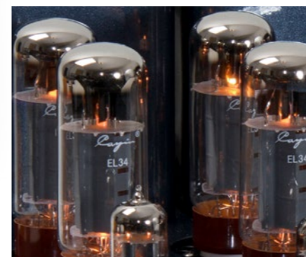
Acht EL34-Röhren in der Ausgangsstufe
